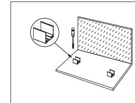
Fissare le clip in alluminio alla superficie di montaggio con il cacciavite.
