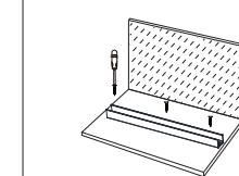
Fissare il profilo in alluminio alla superficie di montaggio con il cacciavite.
