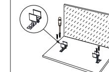
Fissare i supporti orientabili alla superficie di montaggio con il cacciavite, quindi fissare le clip ai supporti orientabili.
