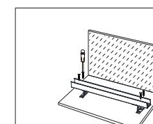
Fissare i supporti orientabili alla superficie di montaggio con il cacciavite, quindi fissare il profilo ai supporti orientabili.
