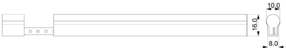
FL220CO - € 3,00 Congiunzione Rettilinea Splice pin for connection
